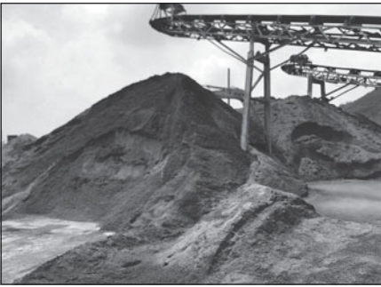
Рис. 2. Производство дробленого песка по технологии мокрого измельчения
