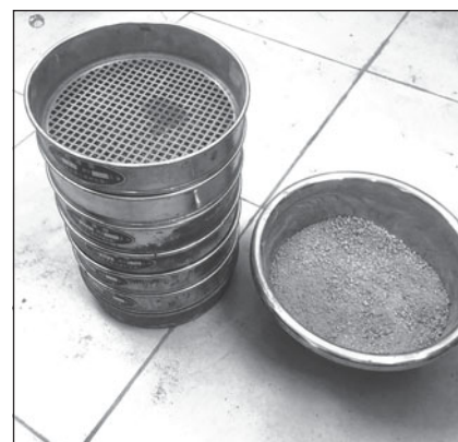
Рис. 6. Стандартный набор сит для просеивания пробы при определении зернового состава дробленого песка
