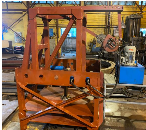
Hình 6: Thiết bị thử nghiệm trục quá tải
