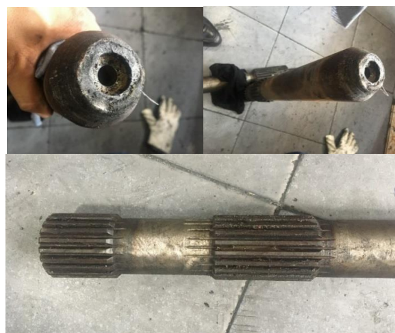
Hình 2: Trục quá tải sau khi bị cắt đứt
