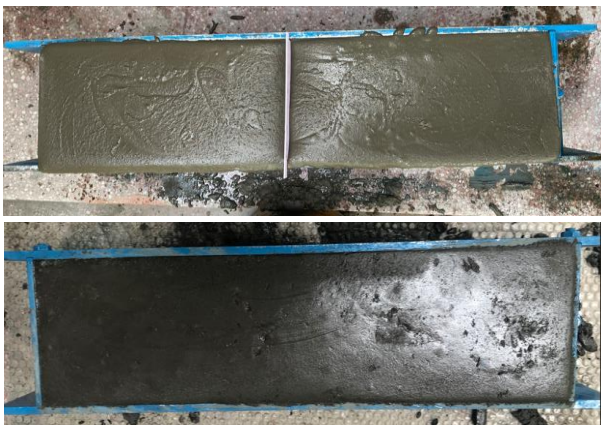
Hình 3. Mẫu bê tông nguyên và mẫu bê tông tạo hình khe nứt mở
