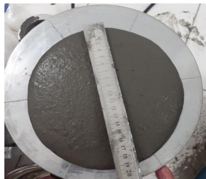
Hình 4. Xác định độ chảy xòe của hỗn hợp vữa chất kết dính trong côn vữa
