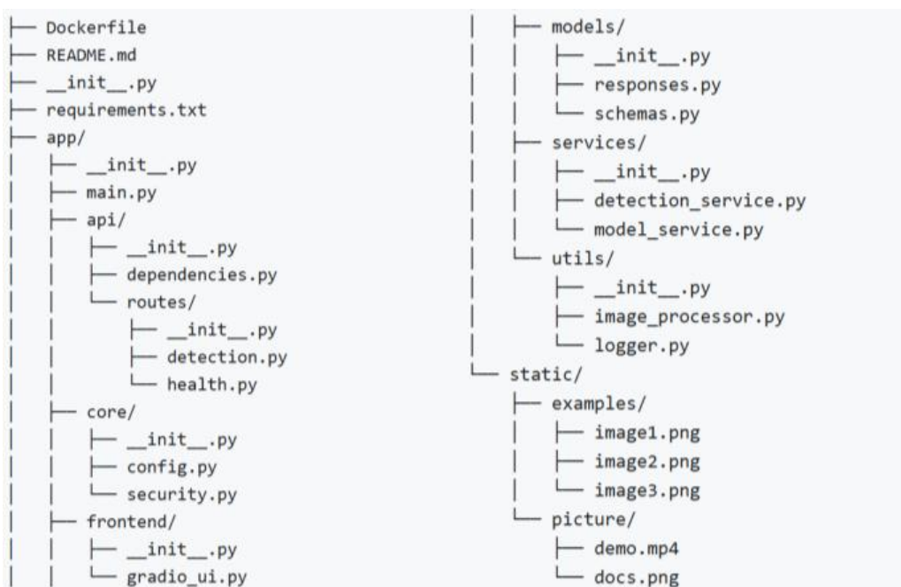
Hình 2: Cấu trúc project triển khai ML/DL Model bằng FastAPI
