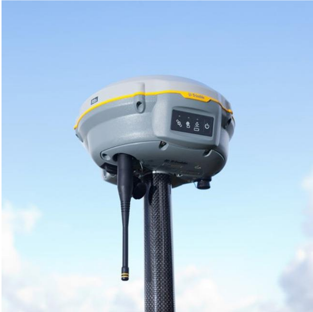
Hình 1. Trimble R8s – một trong những thiết bị nổi bật được sử dụng phổ biến trong phương pháp đo GNSS tĩnh.
