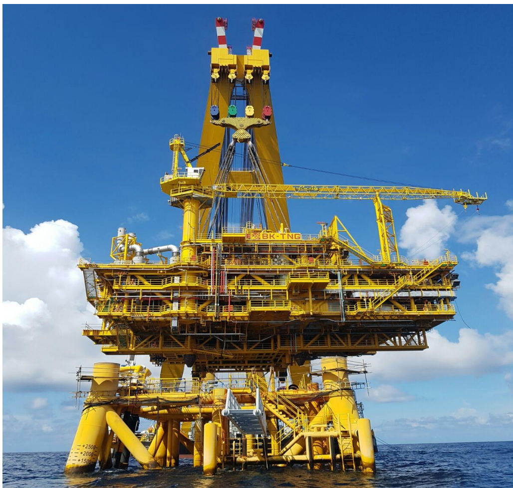
Hình 3. Lắp đặt biển Topside giàn BK-TNG
