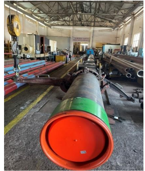
Hình 4. Lắp đặt vòng tăng mômen xoắn (Torque ring) vào đầu nối ống chống
