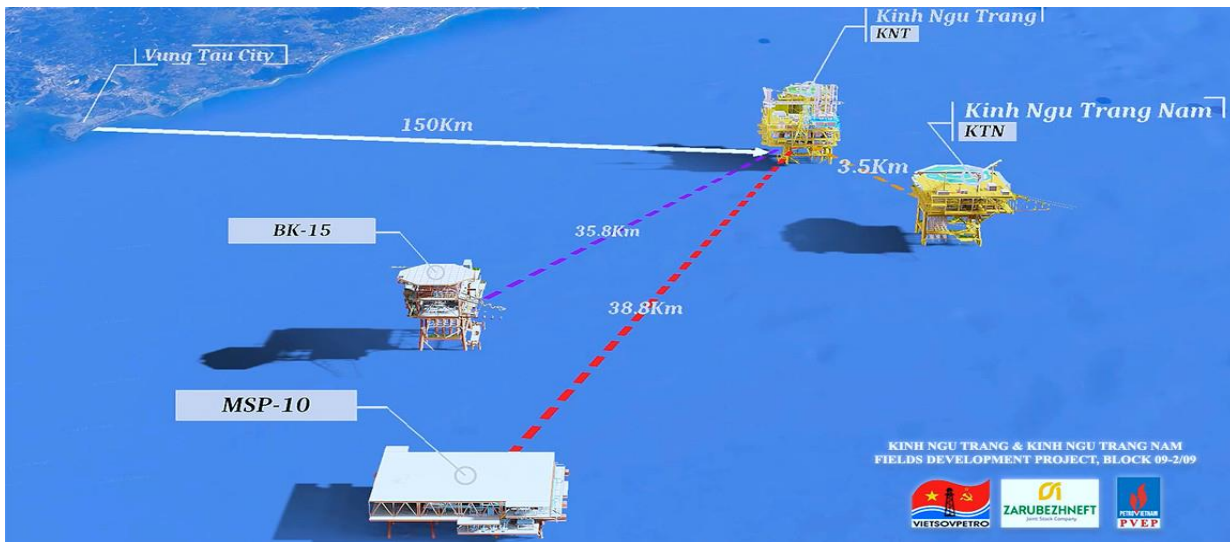
Hình 4. Sơ đồ Phát triển mỏ KNT & KTN Lô 09-2/09
