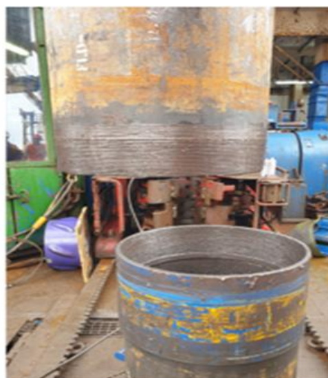
Hình 8. Thực tế hoạt động đang khoan bằng ống chống
