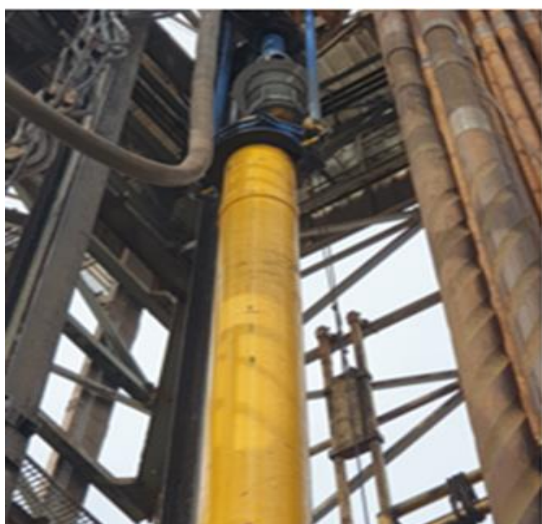
Hình 9. Độ lệch tâm giữa Top Driver và bàn Rotary Table
