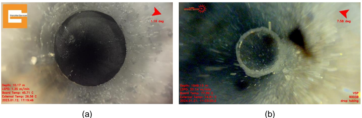
Hình 4. (a): Đứt cần HKT 3.5"OD ở độ sâu 10.3m, giếng 121 giàn MSP-6 (b): Đứt cần HKT 2.875"OD ở độ sâu 1949.5m, giếng 9003E giàn BK-9
