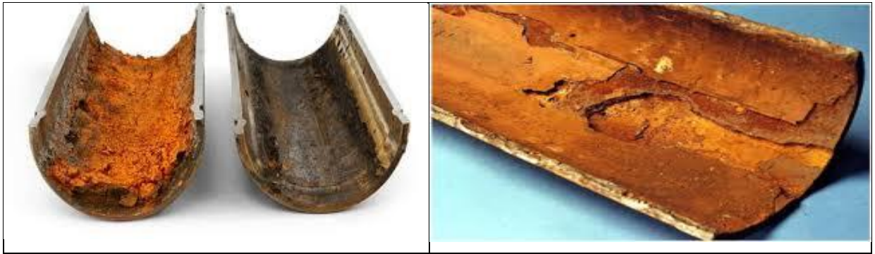
Рис. 5. Примеры корродированного газопровода
