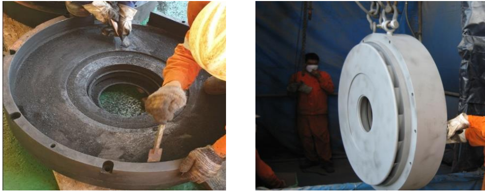
Hình 2. Các Diaphragm trước và sau khi được làm sạch
