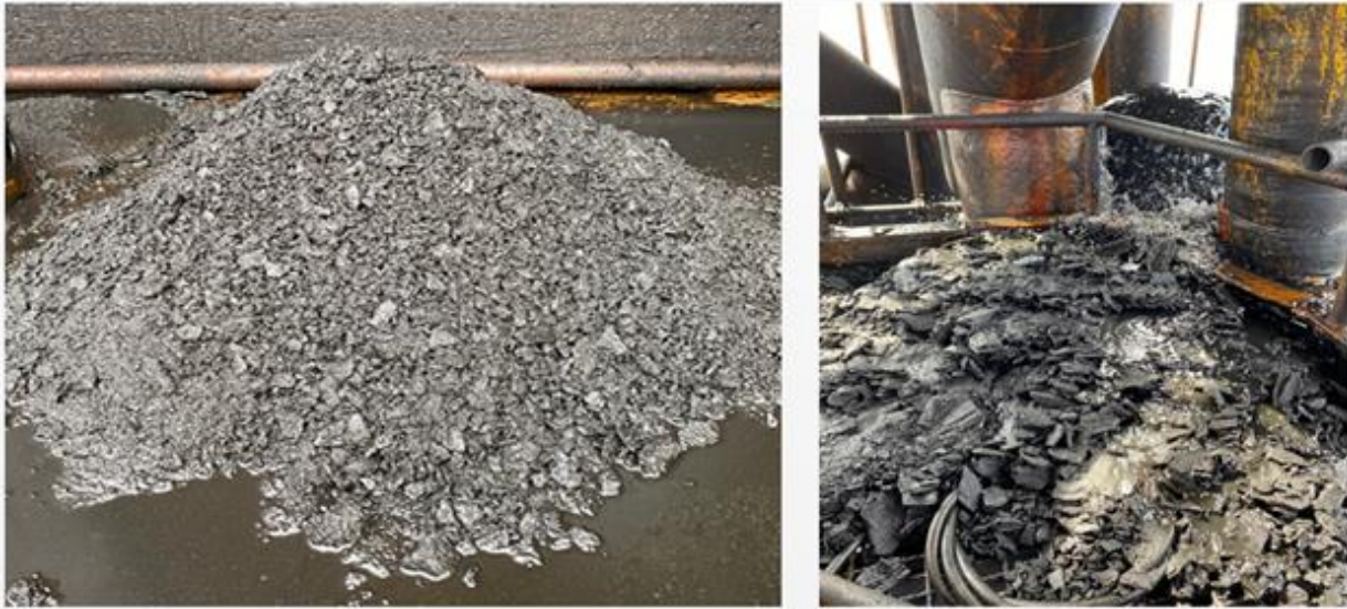
Hình 9. Paraffin cứng thu được trên BK-3, dạng đá phiến, muối mỏ
