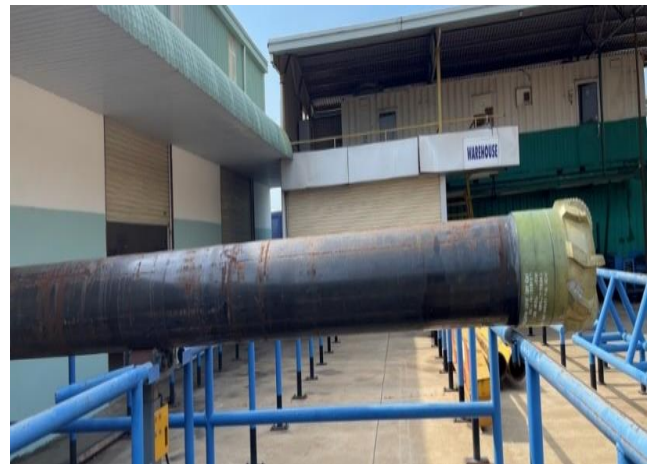
Hình 5. Kết nối sẵn chèo khoan 24" và van ngược vào các đoạn ống tại căn cứ
