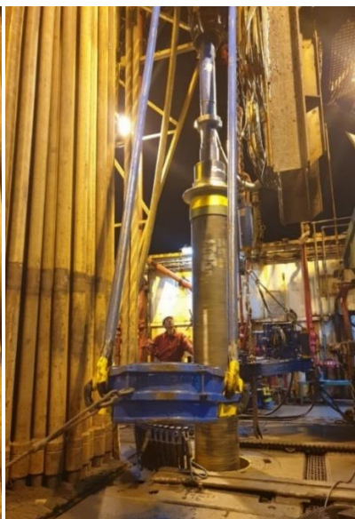
Hình 8. Thực tế hoạt động đang khoan bằng ống chống
