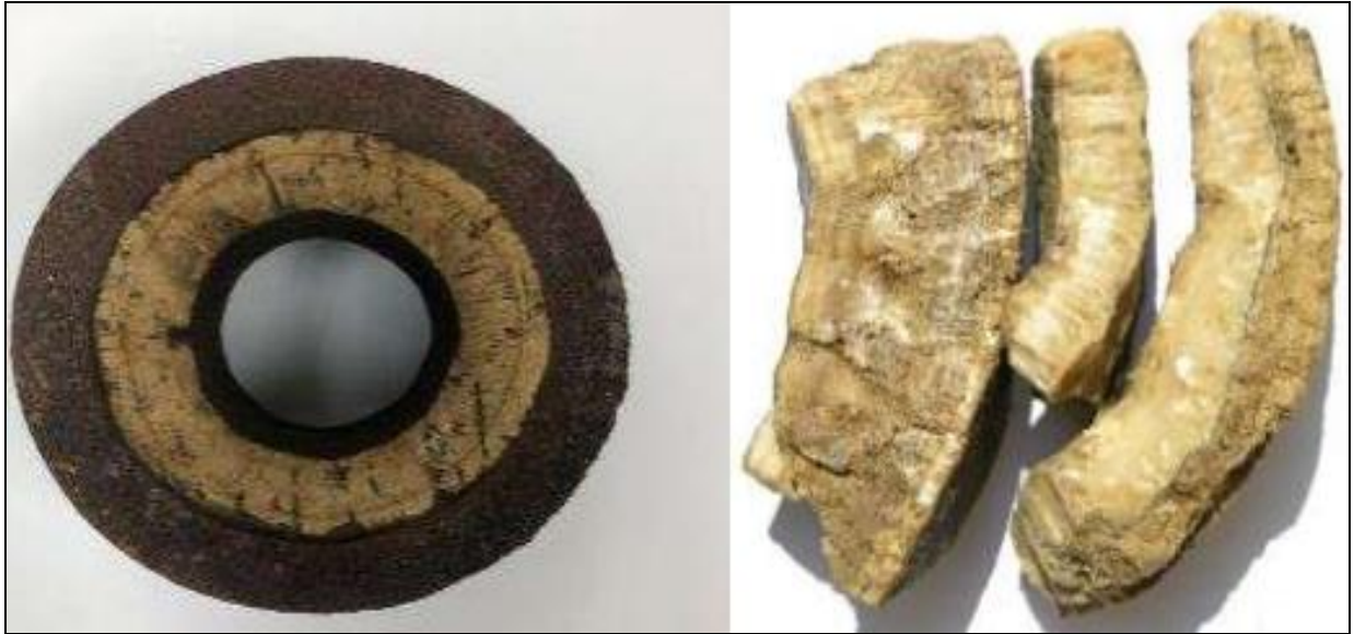
Hình 1. Lắng đọng muối trong đường ống công nghệ
