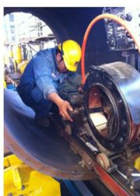
Hình 7. Hàn trong bằng máy hàn 1 mỏ - LT7
