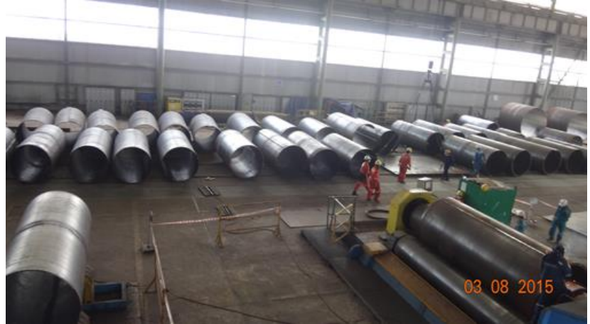
Hình 10. Công trình cuốn ống P7-P10
