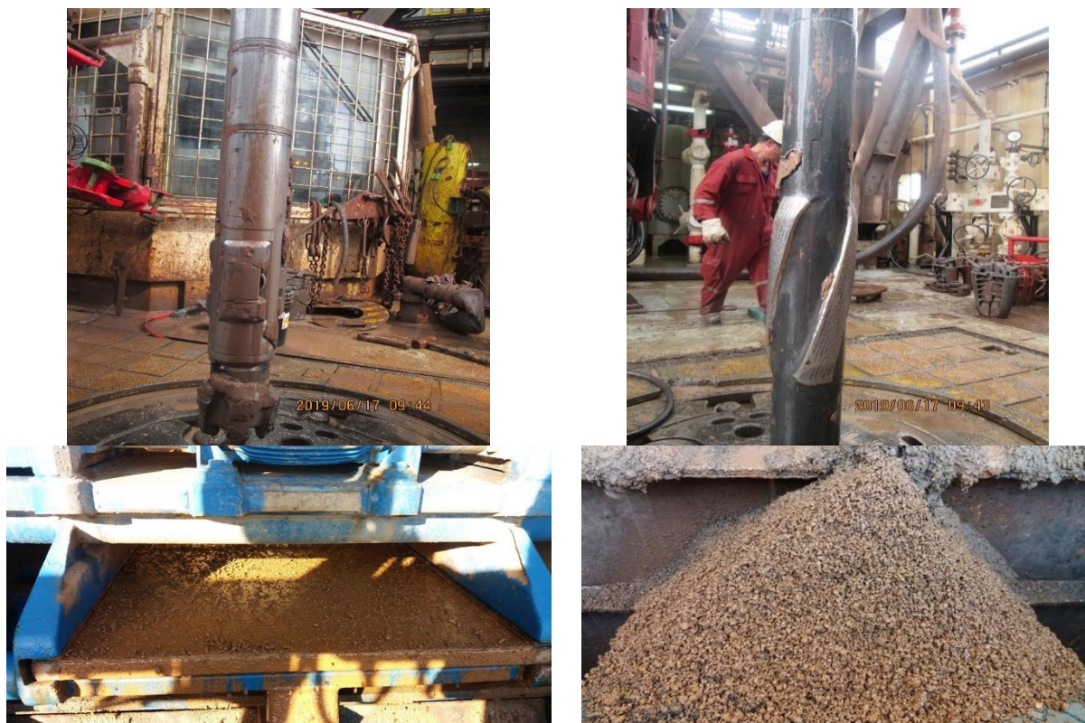
Hình 14. Hình ảnh bộ khoan cụ và mùn khoan tại sàng rung khi thử nghiệm hệ KGAC Plus M1
