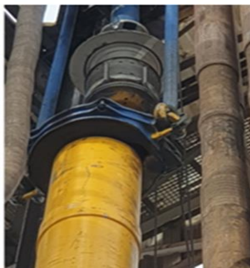
Hình 9. Độ lệch tâm giữa Top Driver và bàn Rotary Table
