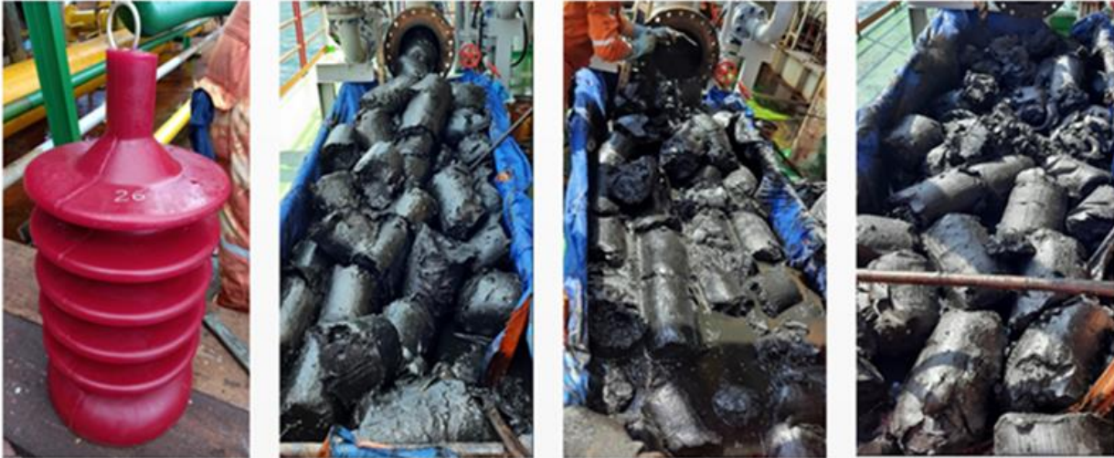
Hình 12. Paraffin dẻo thu được tại RB3/CTK-3 khi phóng thoi UFDP 12"
