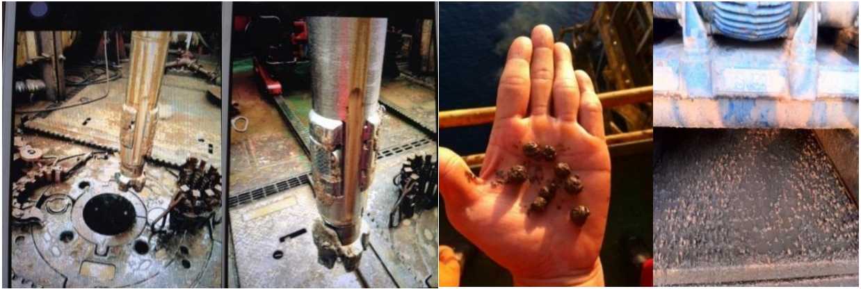
Hình 6. Hình ảnh thực tế thi công tại giàn khoan Tam Đảo 2 - Bộ khoan cụ khi kéo lên rất ít bị dính bám sét, mùn khoan tại sàn rung được ức chế tốt, trạng thái khô, vo viên, không dính bết
