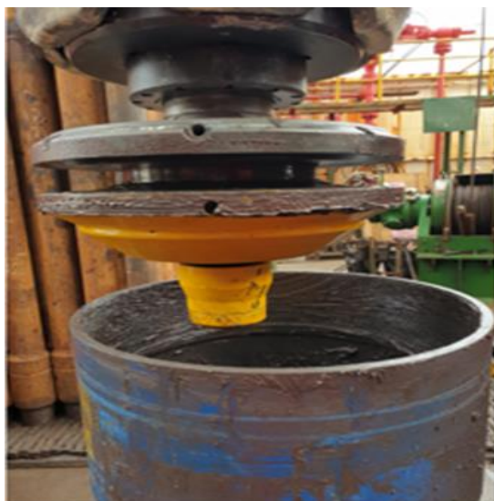
Hình 6. Choòng khoan 24" được gắn trực tiếp vào ống chống
