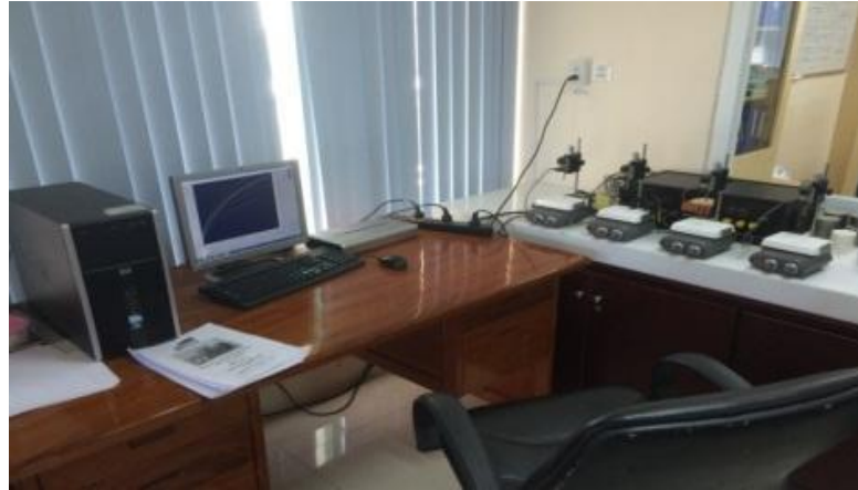
Hình 4. Thiết bị đo trương nở sét Swellmeter
