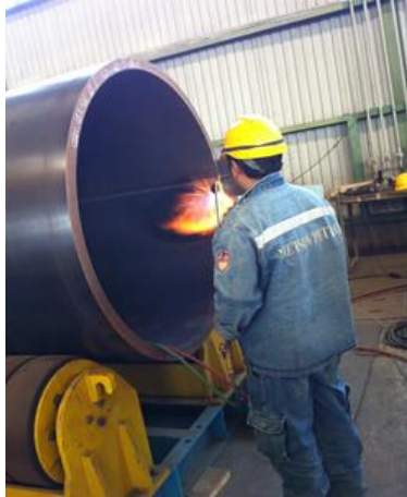
Hình 9. Gia nhiệt mối hàn trước khi hàn
