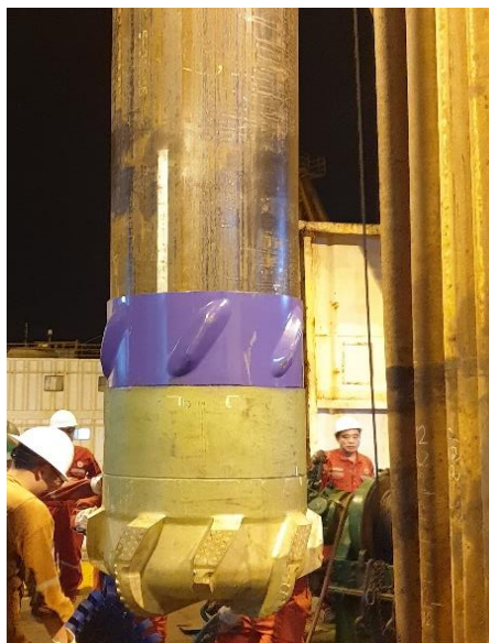
Hình 6. Choòng khoan 24" được gắn trực tiếp vào ống chống
