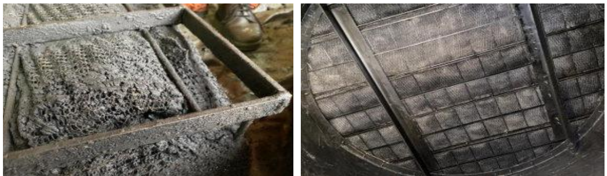
Hình 5. Các lớp lưới bị bám bẩn bởi parafin trước và sau làm sạch
