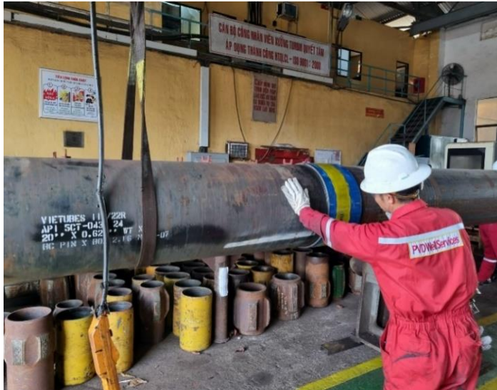
Hình 4. Lắp đặt vòng tăng mômen xoắn (Torque ring) vào đầu nối ống chống
