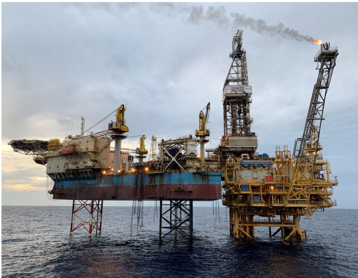
Hình 4. Giàn khoan tự nâng Tam Đảo 02 cập giàn BK-TNG thực hiện công tác khoan
