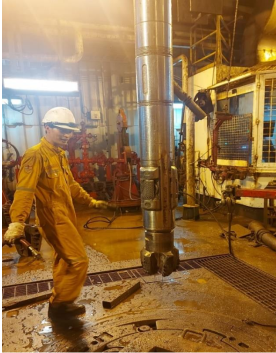
Hình 8. Choòng không bị bám sét sau khi khoan đến chiều sâu 4627m
