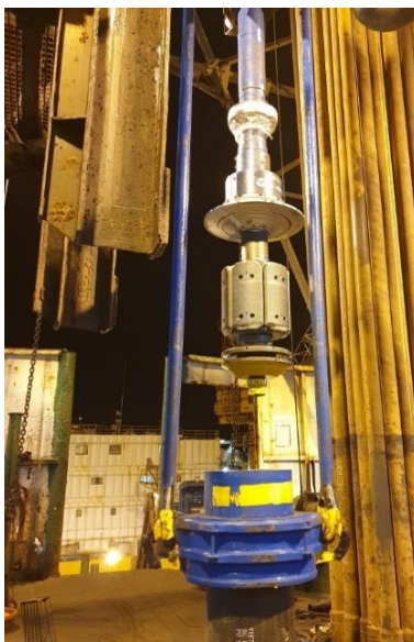
Hình 7. CRTi được lắp trực tiếp vào Top Driver
