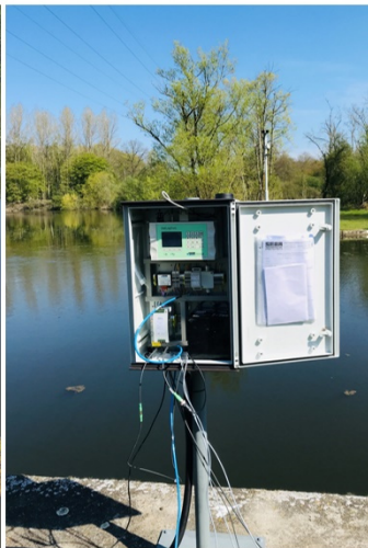
Điểm quan trắc nước mặt, thời gian thực lắp đặt năm 2022 - VIWAT3
