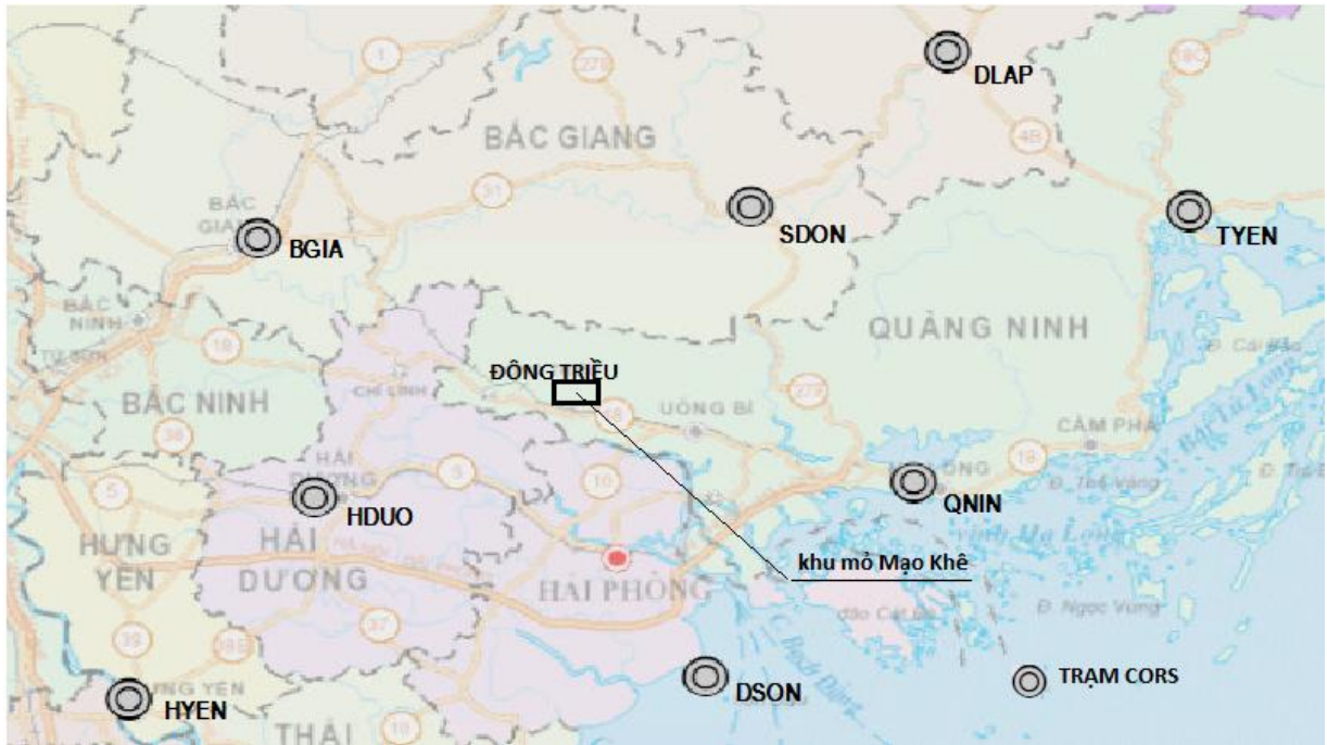
Hình 3. 5 Sơ đồ hệ thống các trạm CORS xung quanh khu vực đo
