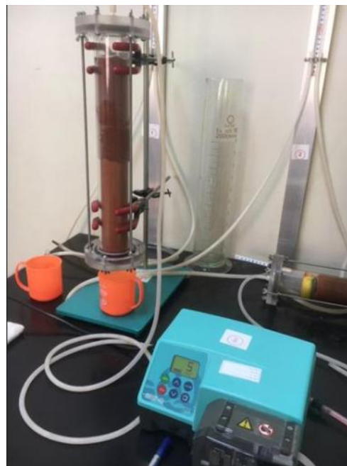
Hình 2.10. Hình ảnh dòng thấm chảy đều theo phẫu diện cột đất cát với tốc độ chuẩn 0.654 cm/phút
