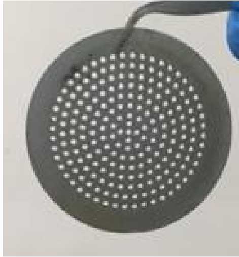
Hình 2.4. Tấm hợp kim nhôm lót đáy ống nhựa dày 5mm, đục lỗ \square 1\text{mm} cho nước thấm chảy qua
