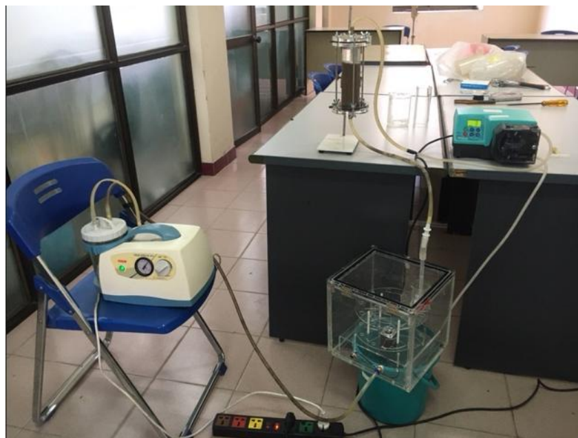
Hình 2.11. Thí nghiệm với cột đất cát pha sét (Phú Diễn, Bắc Từ Liêm, Hà Nội)
