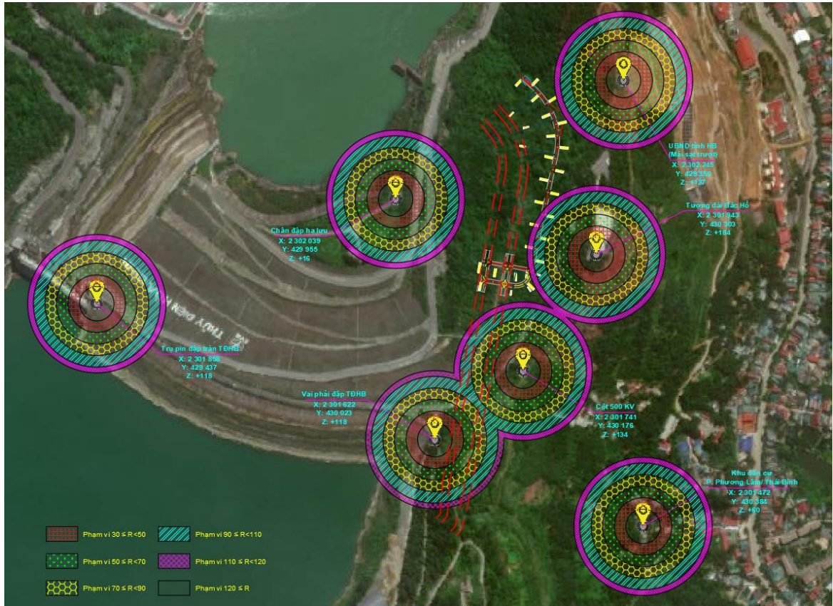
Hình 3.3. Sơ đồ vị trí các công trình cần bảo vệ và khoảng cách an toàn tương ứng khi thi công đào Hàm dẫn nước
