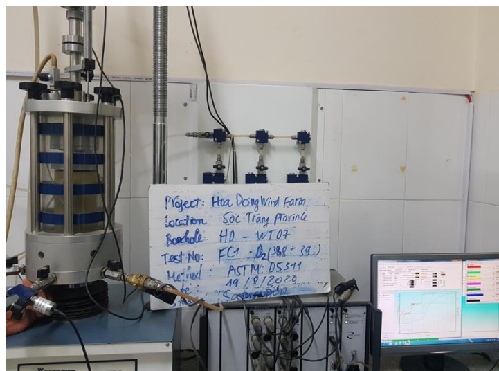
Hình 6. Lắp đặt mẫu vào buồng áp lực
