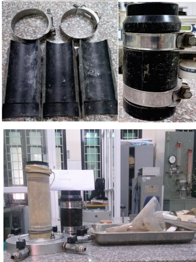
Hình 4. Khuôn và dụng cụ dùng cho chế bị mẫu đất rời
