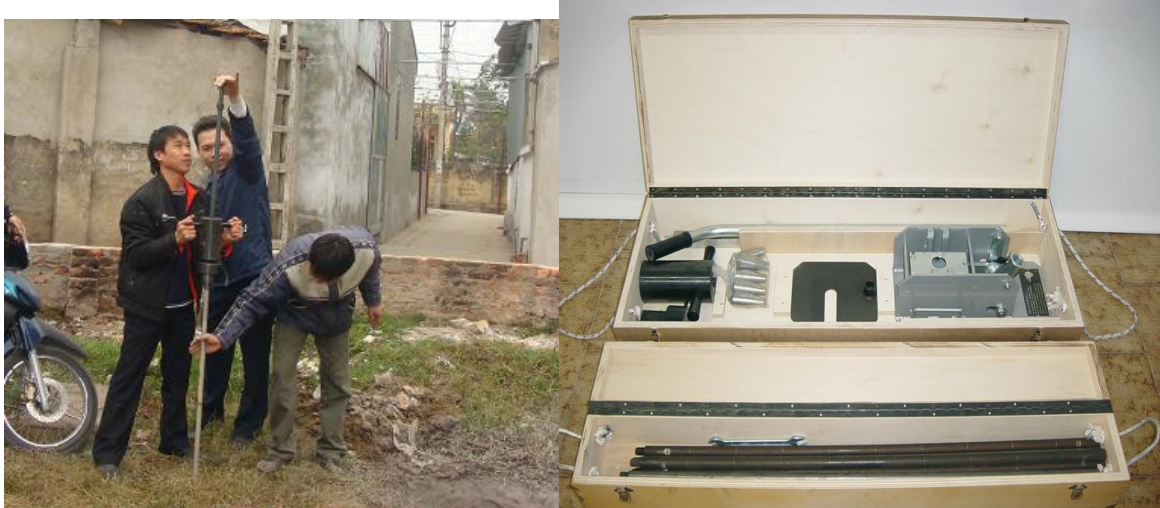
Hình 2. Thiết bị xuyên động loại 10kg của hãng Tecnotest (Italy)
