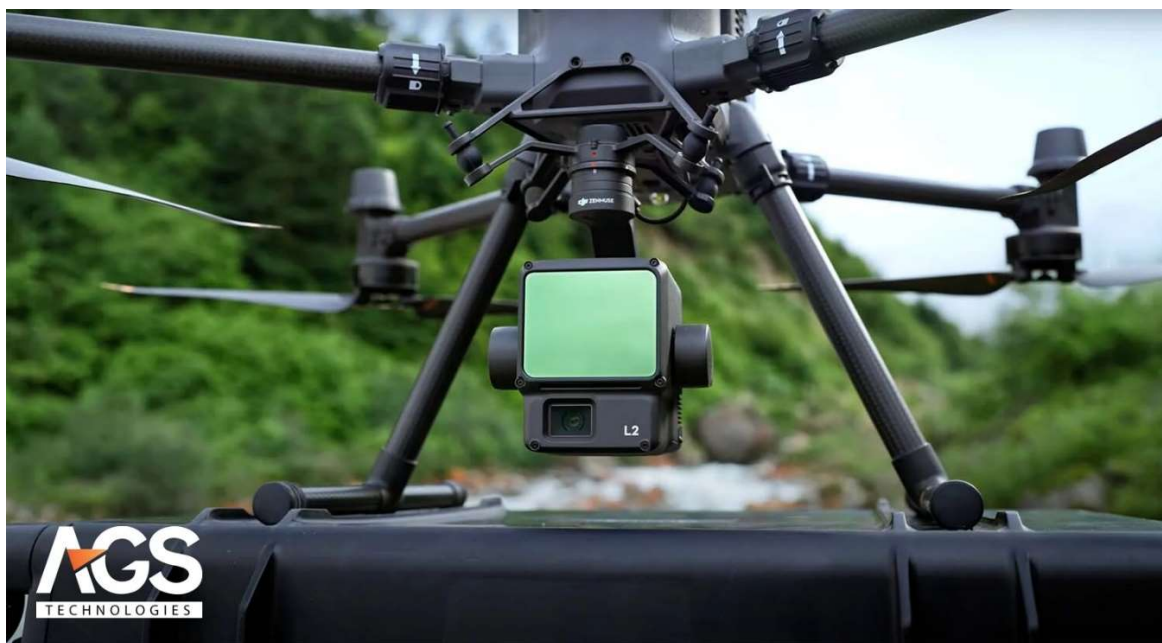
Hình 2.1 Bộ tích hợp Lidar và chụp ảnh số Zenmuse L2 (ảnh AGS)
