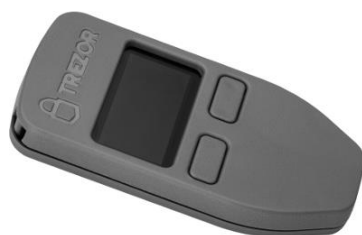
Hình 4. Thiết bị Trezor: ví HD bitcoin trong phần cứng
