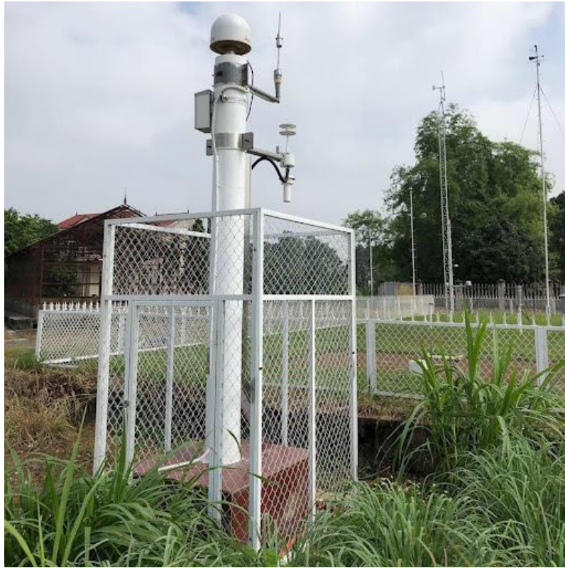
Hình ảnh trạm CORS của cục Đo đạc bản đồ và Thông tin địa lý Việt Nam
