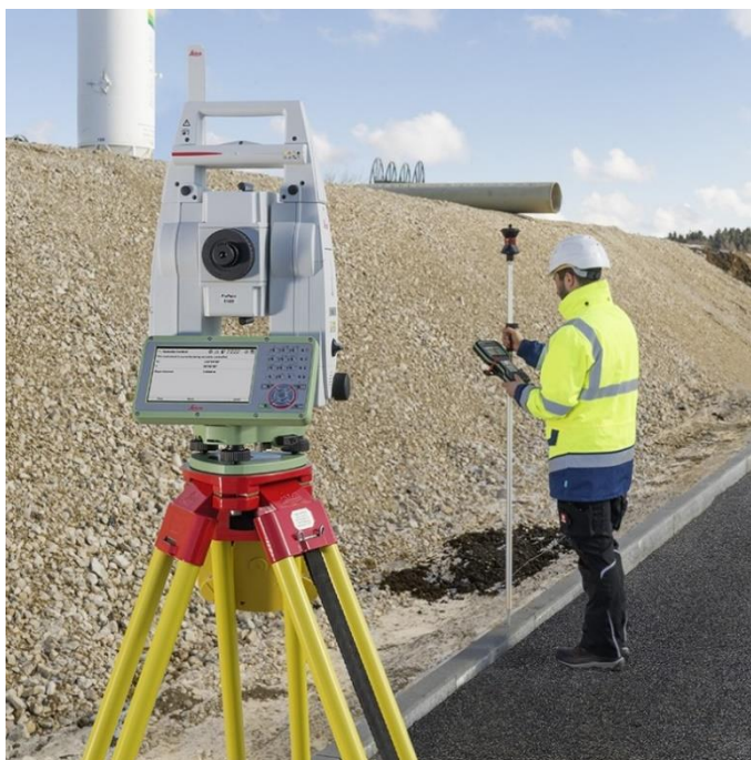
Hình 4.7. Đo đạc bằng máy toàn đạc điện tử
