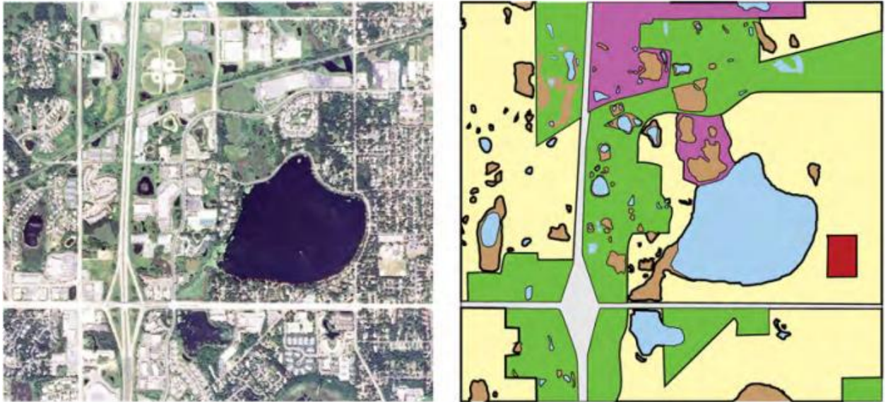
Hình 3.2. Ví dụ dữ liệu không gian raster và vector (Bolstad, 2016)
