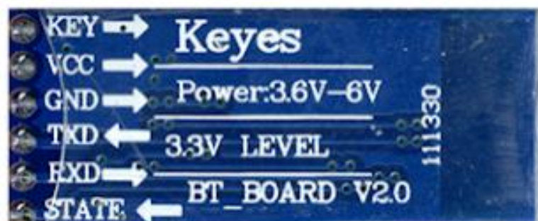
Hình 1.6. Sơ đồ chân cắm của module bluetooth HC-05
