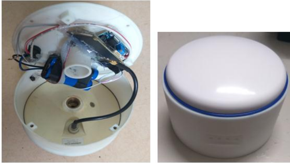
Hình 1.32. Máy định vị GNSS đang lắp ráp và đã hoàn thiện Trạm GNSS CORS quy mô nhỏ được hoàn thiện như ở hình 1.33
