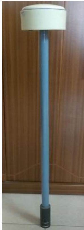
Hình 1.33. Trạm GNSS CORS quy mô nhỏ
