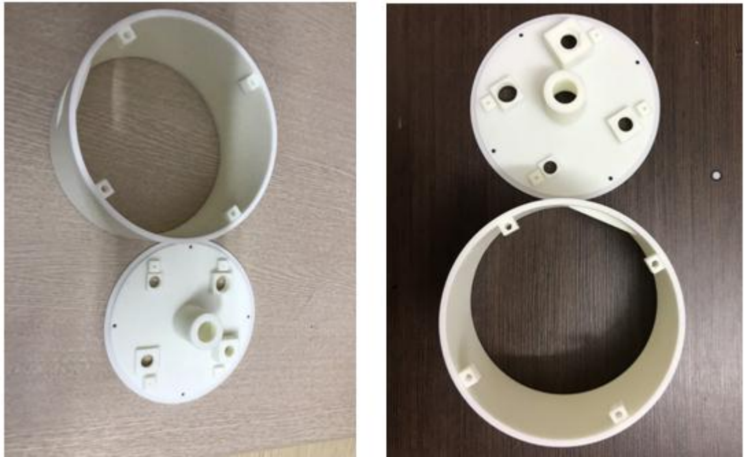
Hình 1.30. Vỏ hộp bộ thu máy định vị vệ tinh GNSS sau khi in 1.4. Lắp đặt các thành phần cho máy định vị GNSS
