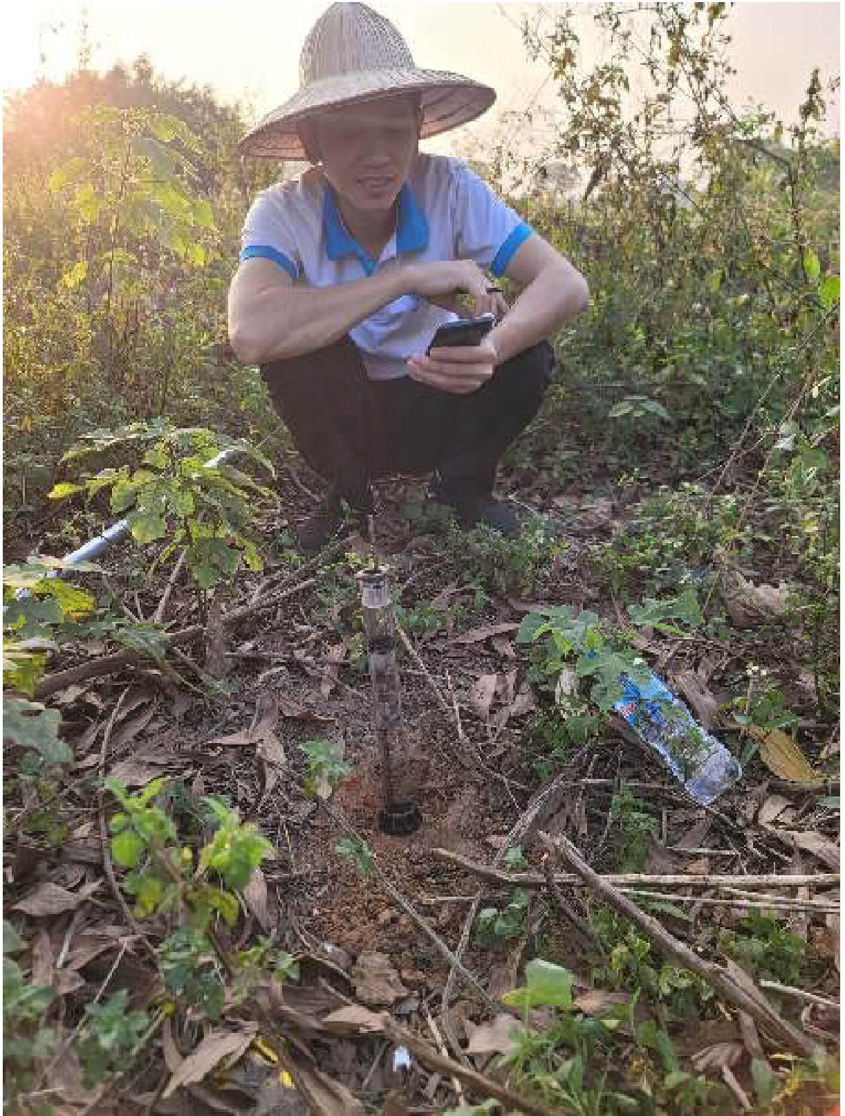
Hình 2.6. Ảnh thí nghiệm xác định tốc độ ngấm không bão hoà của nước trong đới không bão hoà nước tại Bắc Ninh.
