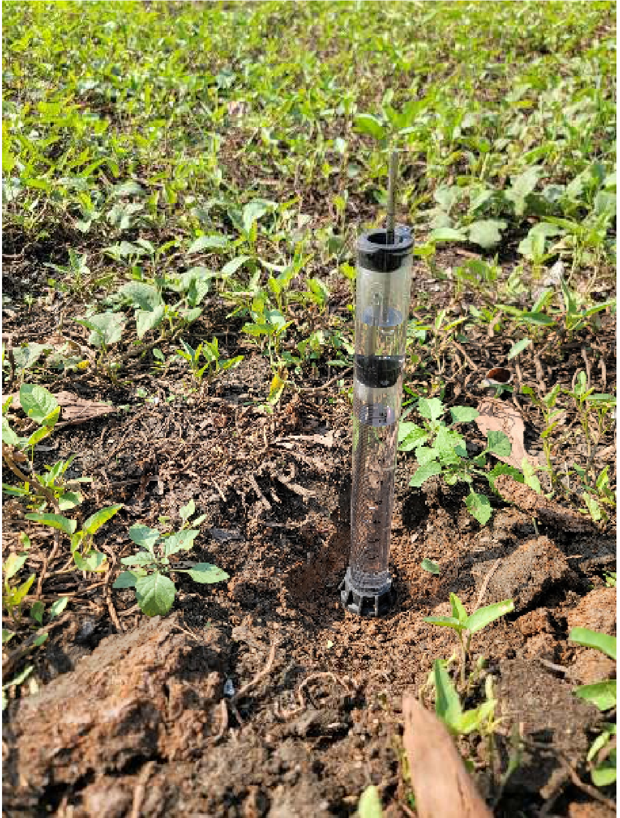
Hình 2.7. Ảnh thí nghiệm xác định tốc độ ngấm không bão hoà của nước trong đới không bão hoà nước tại Bắc Ninh.
