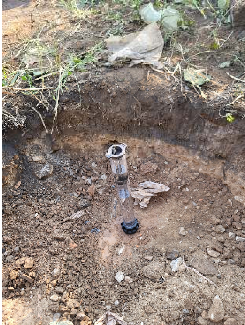
Hình 2.5. Ảnh thí nghiệm xác định tốc độ ngấm không bão hoà của nước trong đới không bão hoà nước tại Bắc Ninh.
