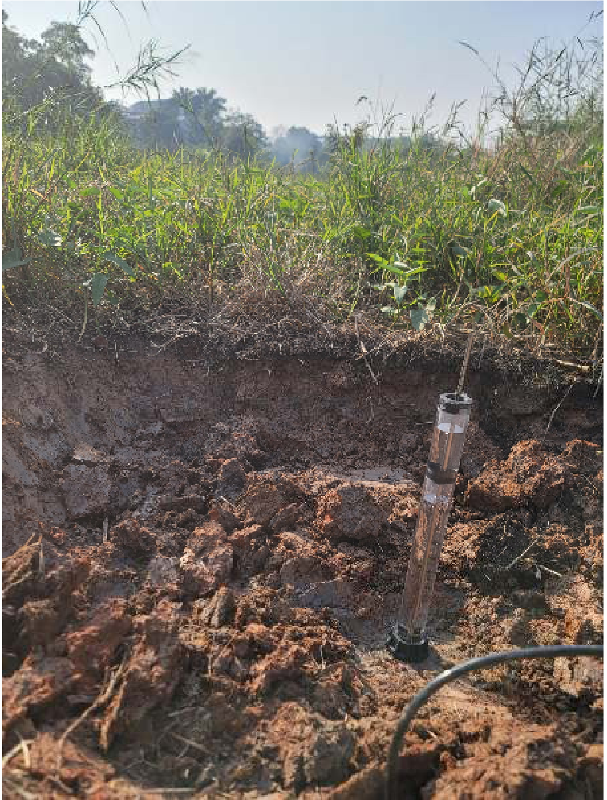
Hình 2.8. Ảnh thí nghiệm xác định tốc độ ngấm không bão hoà của nước trong đới không bão hoà nước tại Bắc Ninh.
