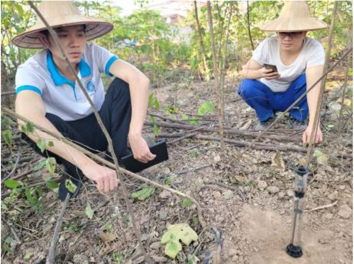
Hình 2.9. Ảnh thí nghiệm xác định tốc độ ngấm không bão hoà của nước trong đới không bão hoà nước tại Bắc Ninh.
