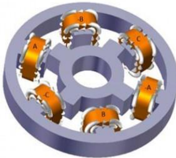
Hình 2- 3 – Nguyên lý cấu tạo cơ bản của động cơ bước
