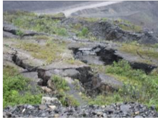
Hình 3.5: Sụt lún và nứt nẻ bề mặt khu vực trung tâm từ +200÷260m
