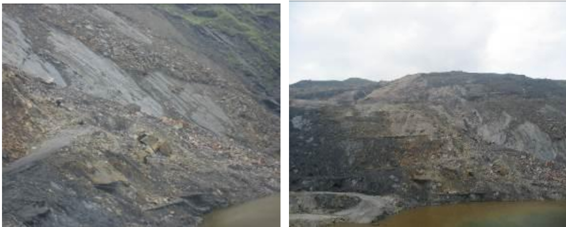
Hình 3.8: Các tầng cắt vào Trụ bị chập chỉ sau 12 tháng
