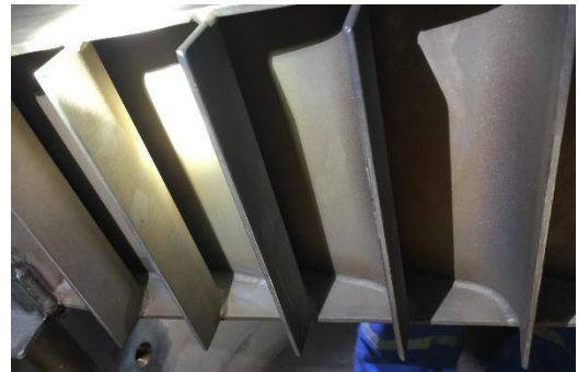
Hình 7: Cấu tạo của bộ phận đầu vào kiểu cánh gạt.
