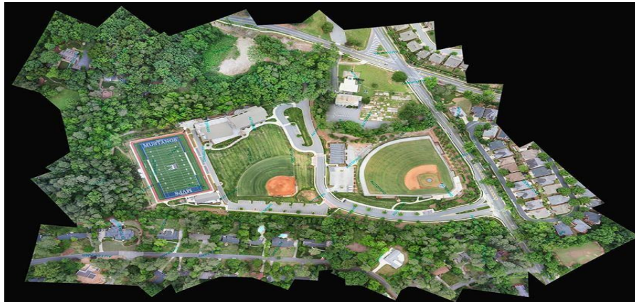
Hình 1. 3: Đo vẽ địa chính bằng ảnh chụp từ máy bay không người lái
