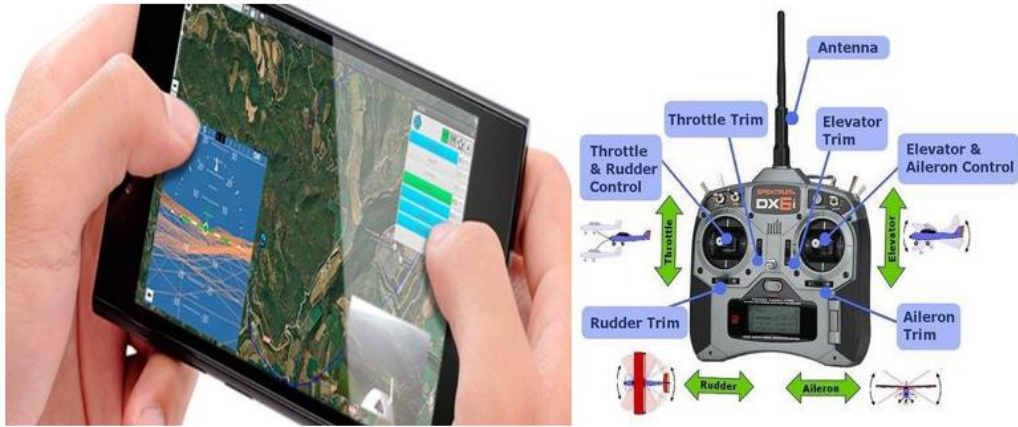
(a) Máy tính bảng để lập trình và điều khiển bay (b) bộ điều khiển thu phát tín hiệu
