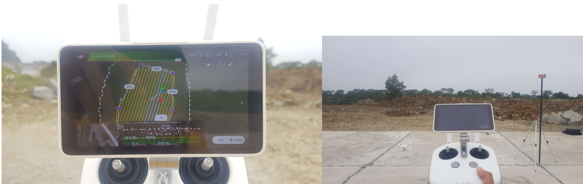
Hình 3.3 Công tác thiết kế bay chụp trên Phantom 4RTK
