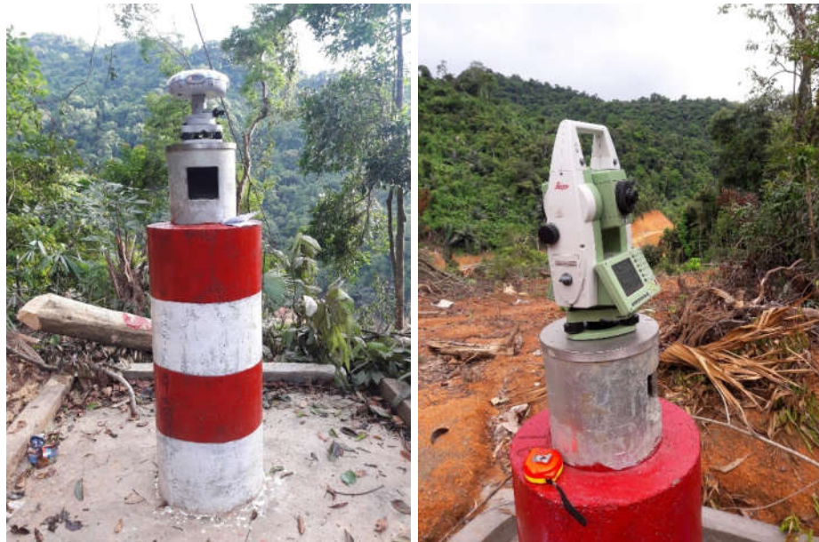
Hình 1.6 Đo lưới tam giác thủy công bằng GPS và toàn đạc [10]
