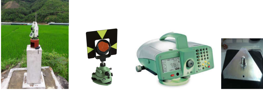
Hình 3.2 Máy móc sử dụng TCR1201, Leica DNA K2 và phụ kiện
