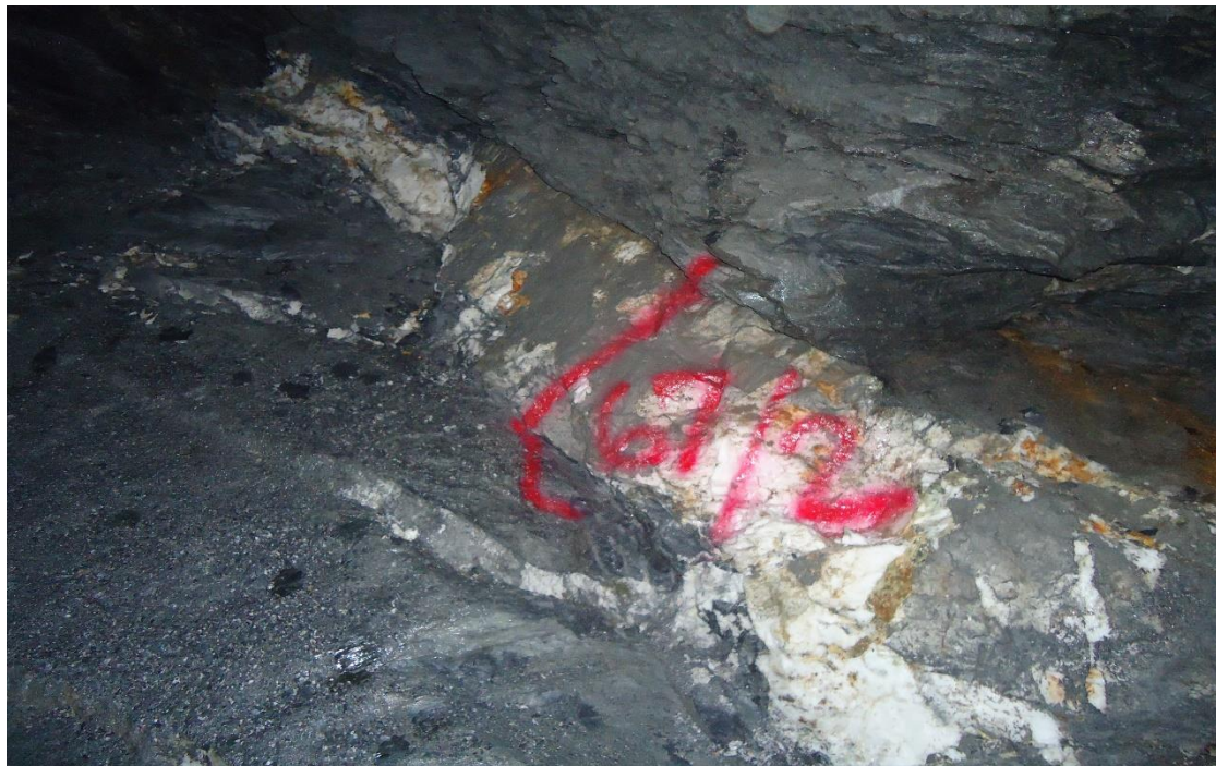
Ảnh II-4: Mạch thạch anh tiêm nhập, lấp đầy trong khe nứt tách đá cát bột kết.
