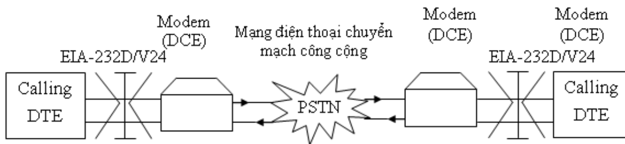
Hình 2.1. Chuẩn giao tiếp EIA – 232D/V24
