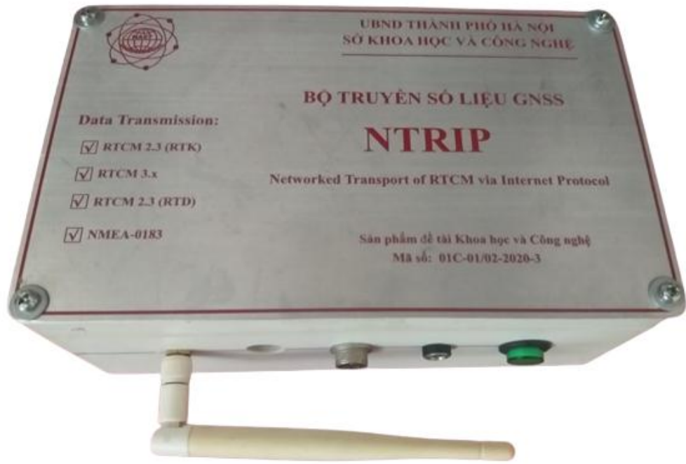
Hình 2.18. Bộ truyền số liệu GNSS cho trạm quan trắc
