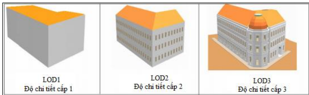
HÌNH 2.13. CẤP ĐỘ CHI TIẾT LoD ĐỐI VỚI CÁC ĐỐI TƯỢNG NHÀ, KHỐI NHÀ
