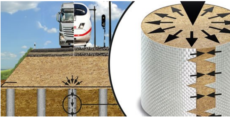
Hình 6.6. Sơ đồ làm việc của nền đắp trên đất yếu gia cố bằng cọc đá dăm bọc vải ĐKT. Cân bằng của ứng suất theo phương đứng và phương ngang trong cọc đá dăm bọc vải ĐKT (Raithel (1999, 2000) và EBGeo 2011)
