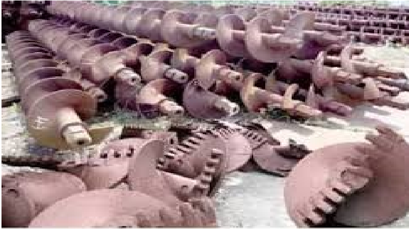
Hình 5.24. Lưỡi khoan guồng xoắn dùng để thi công cọc cát biển - xi măng
