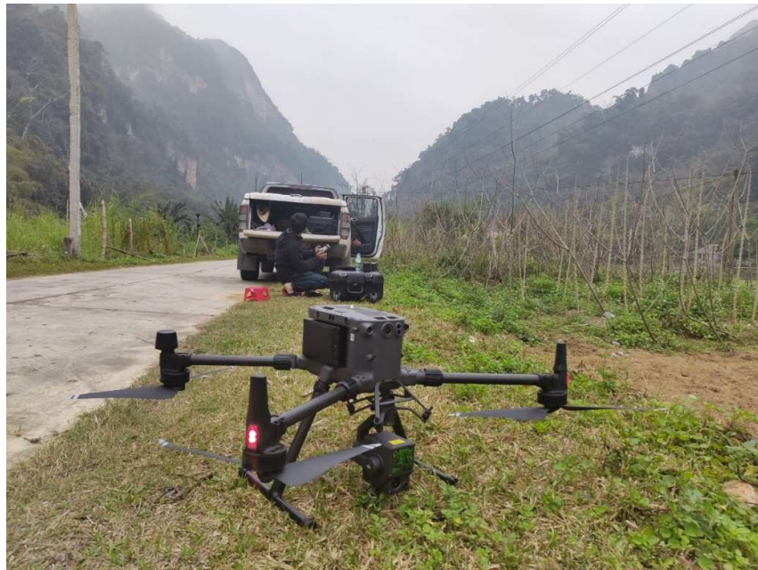
Hình 1.1 Máy bay không người lái M300 và bộ quét tích hợp Lidar ảnh số Zenmuse L1
