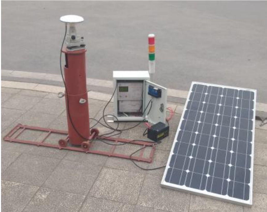
Hình 11. Hệ thống trạm quan trắc trượt lở đất đá theo thời gian thực
