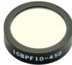
Hình 3. Một kính lọc dải hẹp (bandpass filter) của hãng Newport, ánh sáng sau khi lọc có đỉnh tại 450nm và có độ rộng là 10nm
