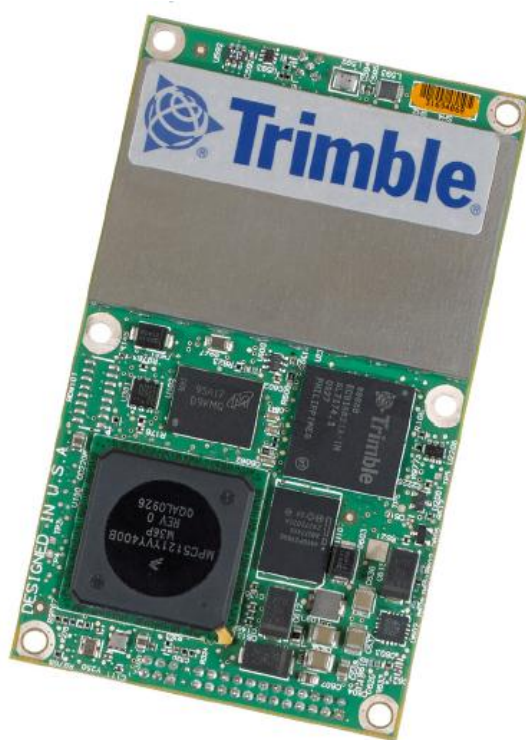
Hình 4. Module thu nhận tín hiệu vệ tinh GNSS Trimble BD970
