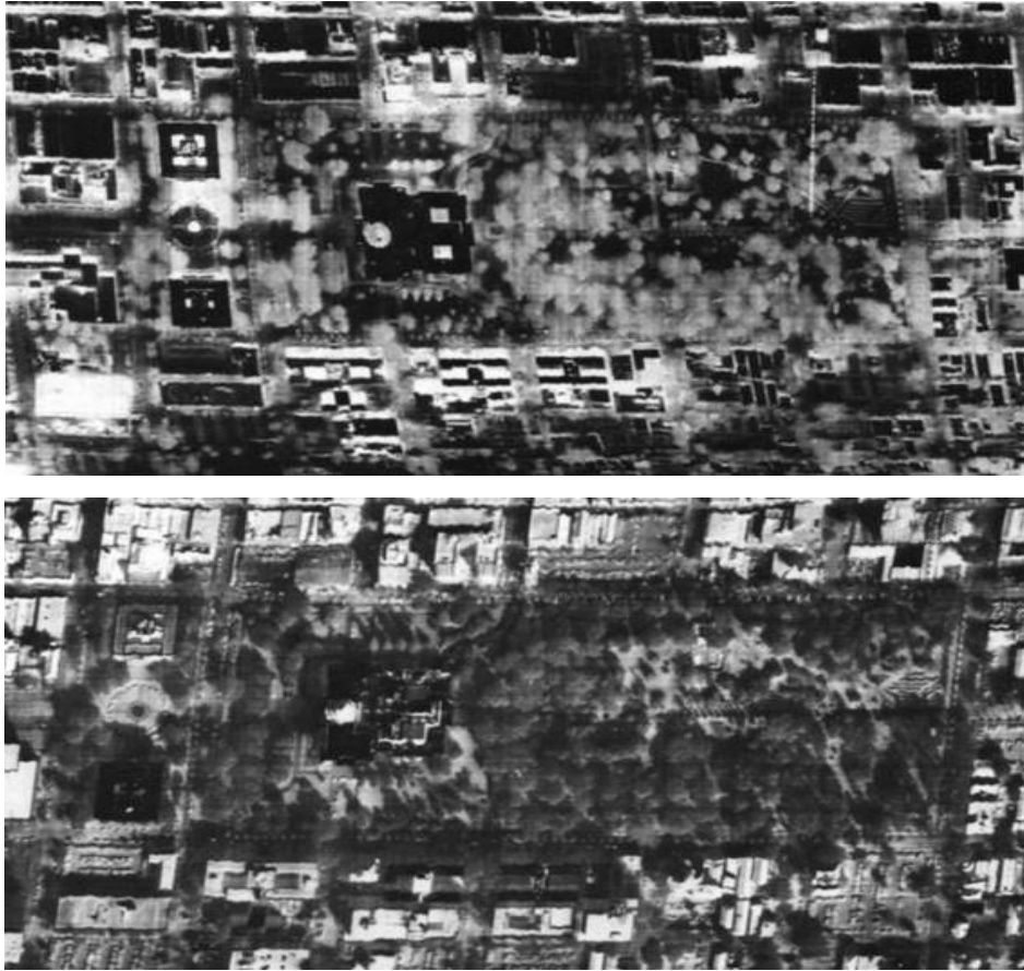
Hình 3. Ảnh hồng ngoại nhiệt thu nhận vào ban ngày (trên) và ban đêm (dưới)
