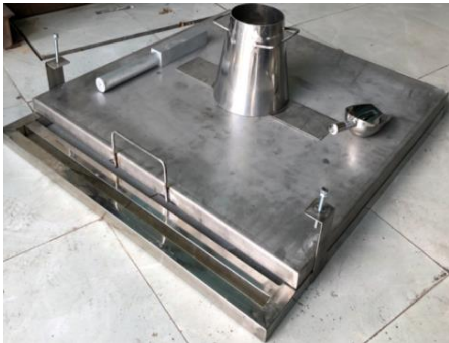
Hình 10. Xác định độ xòe côn nhỏ và độ chảy của hỗn hợp bê tông TNSC trên mô hình
