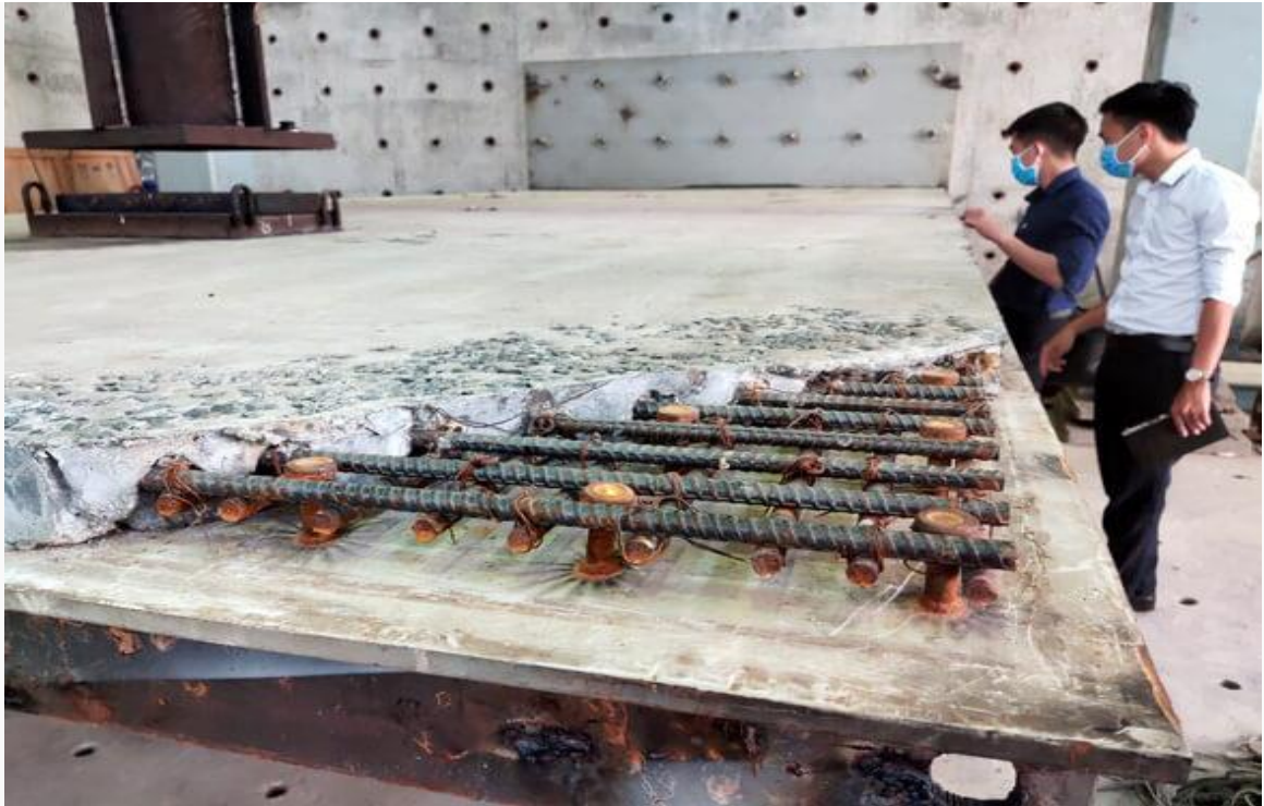
Hình 21. Nghiên cứu dùng BTCT với BTTNSC sửa mặt cầu Thăng Long
