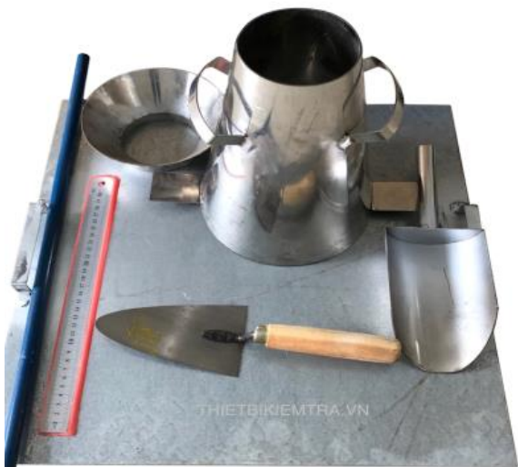
Hình 11. Dụng cụ và cách xác định độ sụt của hỗn hợp bê tông TNSC
