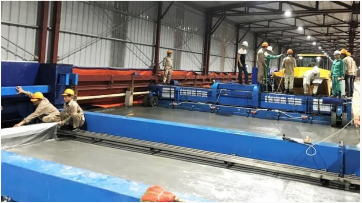
Hình 27. Công tác bảo dưỡng bê tông TNSC
