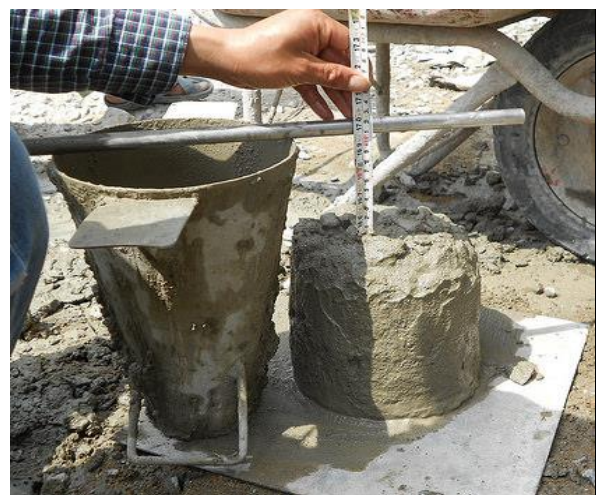
Hình 11. Dụng cụ và cách xác định độ sụt của hỗn hợp bê tông TNSC
