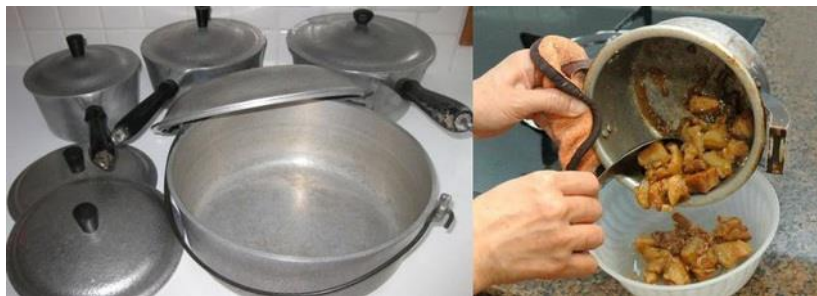
Hình 1.19 - Các sản phẩm xoong, nồi sản xuất từ nhôm tái chế thường chứa chì
