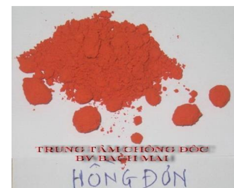
Hình 1.11 - Mẫu hồng đơn (ở chợ TP. Hà Tĩnh, 2001), hàm lượng chì trên 60%
