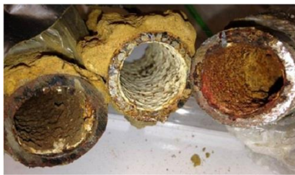
Hình 1.17 - Đường ống rỉ sét là nguyên nhân gây nhiễm chì ở nước
