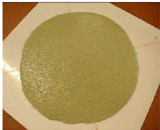
Hình 2.4. Thí nghiệm độ chảy
