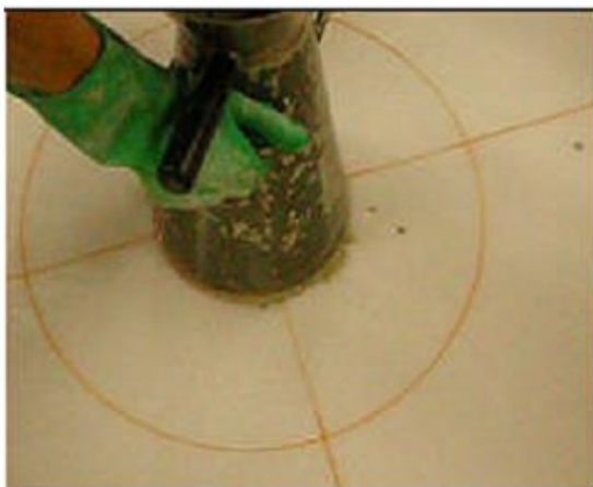
Hình 2.4. Thí nghiệm độ chảy
