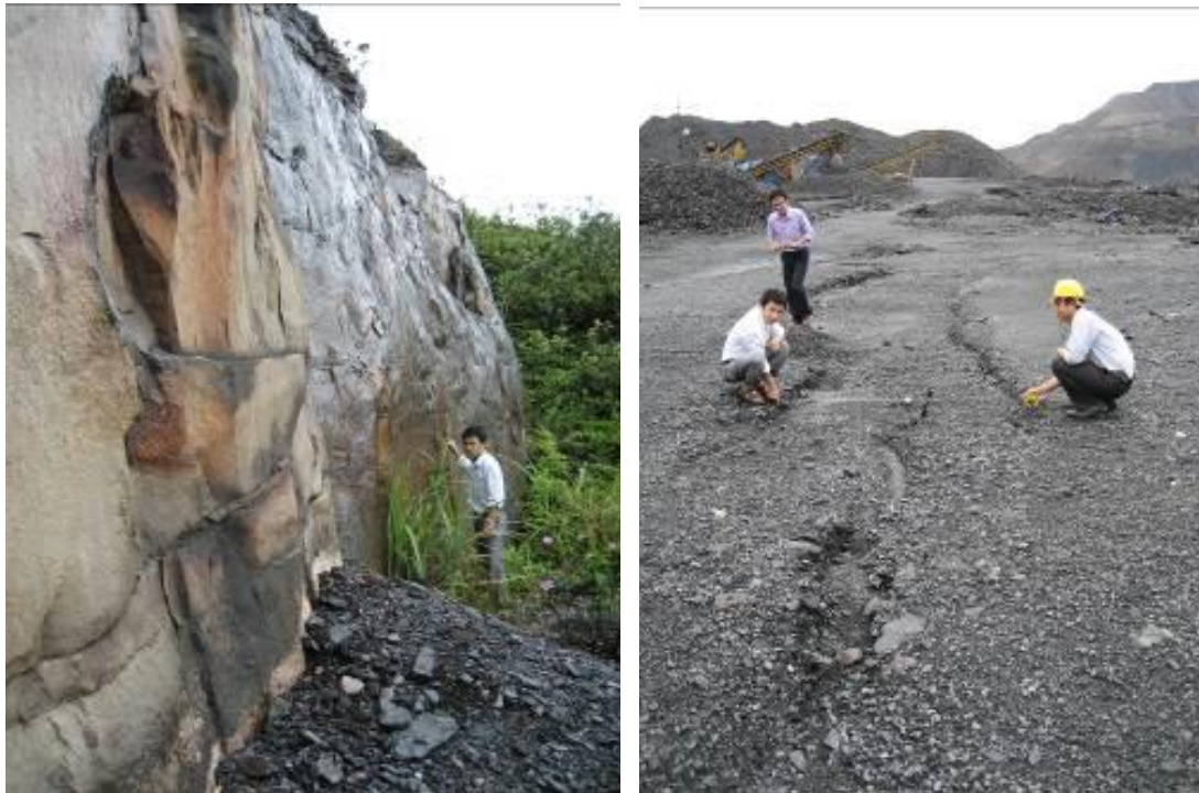
Hình 3.3: Xuất lộ ranh giới trượt trên cùng trùng với đứt gãy K
