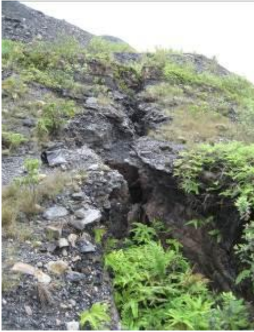
Hình 3.4: Khe nứt trượt phát triển tại khu vực trung tâm trên cao trình +240÷260m
