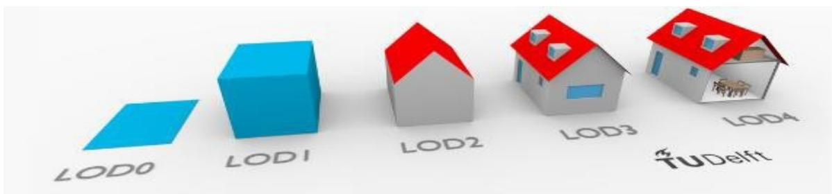
Hình 4. Các cấp độ chi tiết từ LoD0, LoD1, LoD2, LoD3 và LoD4 của đối tượng nhà
