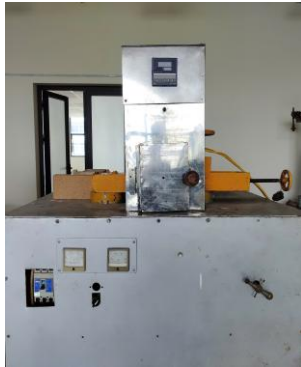
Hình 3. Ảnh thiết bị áp từ VCN-01 tích hợp lò nung xử lý từ nhiệt kèm theo.
