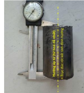
Hình 4. Ảnh mẫu phôi hợp kim Alnico \text{AlNiCuCo35Ti5Nb} thu được bằng công nghệ đúc kết tinh định hướng.
