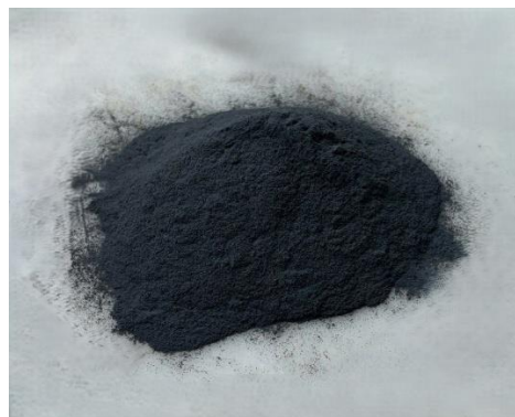
Hình 5. Phụ gia siêu mịn Silica fume SF-90 của Công ty Vina Pacific
