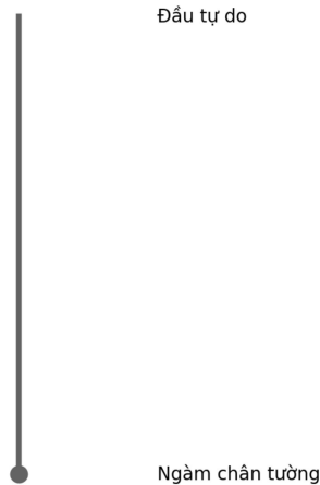
Sơ đồ mô hình tường trong ETABS (phần tử thanh - 1 đầu ngàm, 1 đầu tự do)
