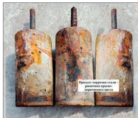
Рис. 10. Армированные бетонные образцы для испытаний на стойкость к коррозии по стандарту NT Build 365
