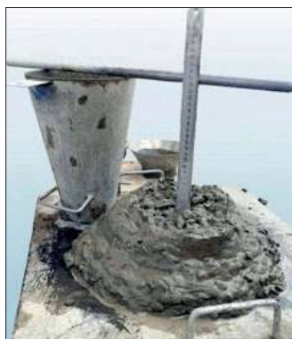
Рис. 9. Определение удобоукладываемости бесцементной бетонной смеси Fig. 9. Determination of workability of cement-free concrete mixture
