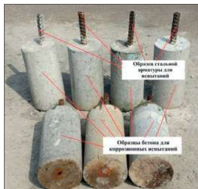
Рис. 10. Армированные бетонные образцы для испытаний на стойкость к коррозии по стандарту NT Build 365
