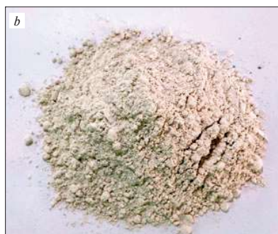
Рис. 4. Компоненты активной минеральной порошковой добавки: a – зола-уноса ТЭС; b – тонкоизмельченный доменный шлак Fig. 4. Components of the active mineral powder additive: a – fly ash from thermal power plants; b – finely ground blast furnace slag
