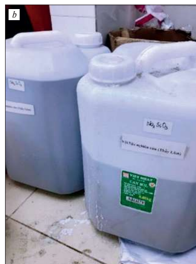
Рис. 5. Компоненты активирующего раствора: a – сухой гидроксид натрия; b – раствор силиката натрия Fig. 5. Components of the activating solution: a – dry sodium hydroxide; b – sodium silicate solution
