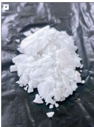
Рис. 5. Компоненты активирующего раствора: a – сухой гидроксид натрия; b – раствор силиката натрия Fig. 5. Components of the activating solution: a – dry sodium hydroxide; b – sodium silicate solution
