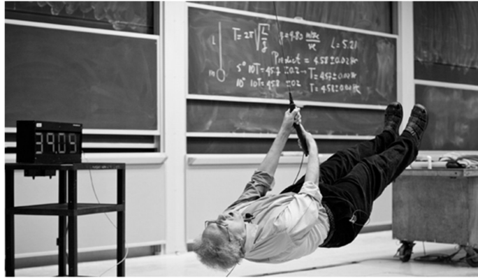
Hình 1. Giáo sư Walter Lewin thực hiện thí nghiệm với con lắc đơn tại một tiết giảng dạy Vật lý tại Viện Công nghệ Massachusetts, Mỹ để kiểm chứng chu kỳ con lắc không phụ thuộc vào khối lượng con lắc.
