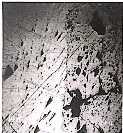
Ảnh 10. Ranh giới phẳng giữa sphalerit (Spl) và galenit (Gal)
