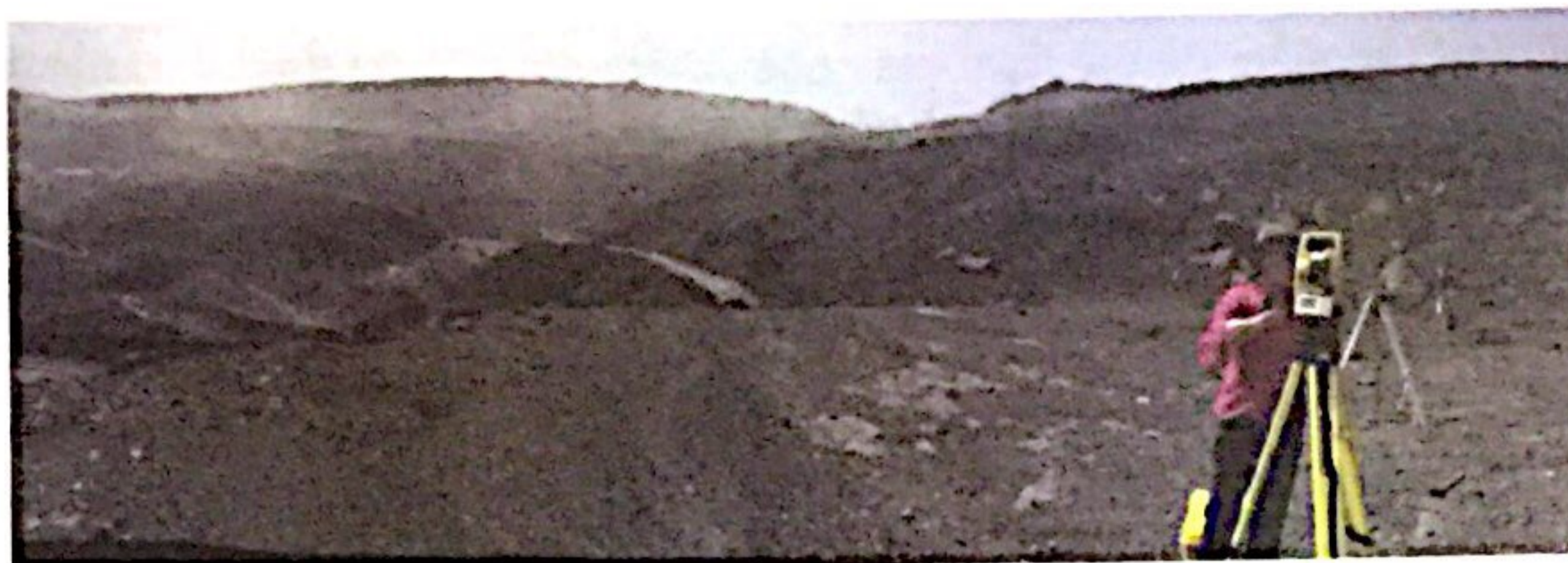
Hình 4: Sử dụng Topcon GPT7501 kiểm tra tọa độ và khoảng cách các mốc đo bằng SPS Zoom 300 tại mỏ Cọc Sáu
