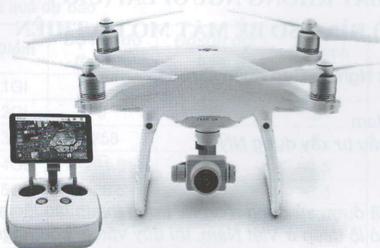
Hình 1. Thiết bị bay Phantom 4 pro và bộ điều khiển trên thân máy bao gồm các cảm biến tránh va đập theo 5 hướng (trái, phải, trước, sau, dưới), bốn mô tơ, 4 cánh quạt có thể tháo rời, chân hạ cánh cố định phía bên dưới.
