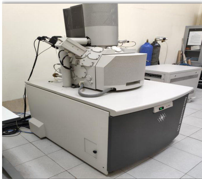
Hình 7. Hệ thiết bị SEM JSM - IT100 tích hợp EDS (Hình trái) tại Trường Đại học Việt Nhật và Kính hiển vi điện tử quét phát xạ trường NanoSEM 450 (Hình phải) tại Khoa Vật lý, Trường Đại học Khoa học Tự nhiên, ĐHQGHN.
