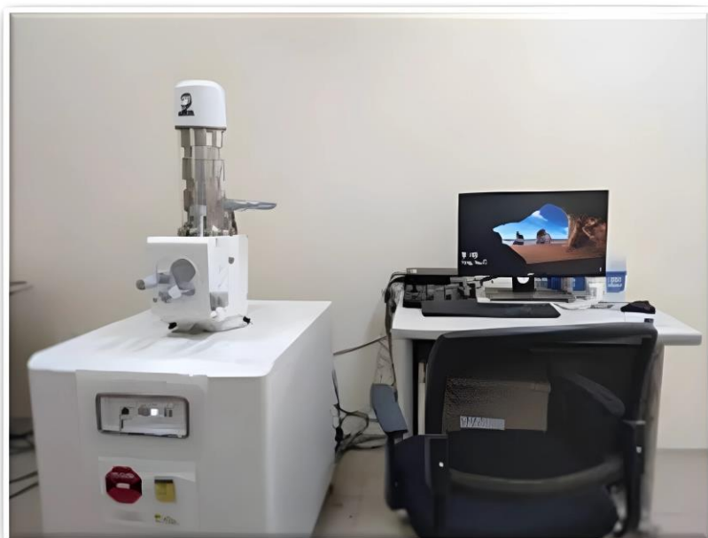
Hình 7. Hệ thiết bị SEM JSM - IT100 tích hợp EDS (Hình trái) tại Trường Đại học Việt Nhật và Kính hiển vi điện tử quét phát xạ trường NanoSEM 450 (Hình phải) tại Khoa Vật lý, Trường Đại học Khoa học Tự nhiên, ĐHQGHN.
