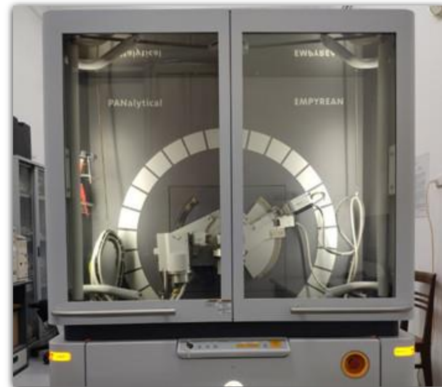
Hình 8. Thiết bị máy đo nhiễu xạ tia X PANalytical EMPYREAN, khoa Vật lý, trường Đại học Khoa Tự nhiên, ĐHQGHN.
