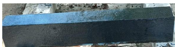
Hình 17. Các dầm được gia cường hoàn thiện
