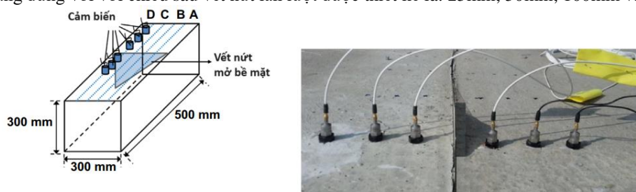
Hình 3. Thí nghiệm SWTM đánh giá chiều sâu vết nứt, Foo Wei Lee và cộng sự (2016)
