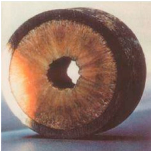
Hình 1. Lượng sáp làm giảm đường kính hiệu quả trong đường ống
